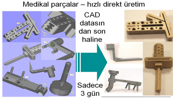
Şekil 3. hızlı direkt imalattaki implant uygulamaları[3].
