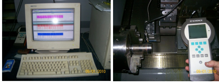
Şekil 1. Kuvvet ve titreşim ölçüm standı
