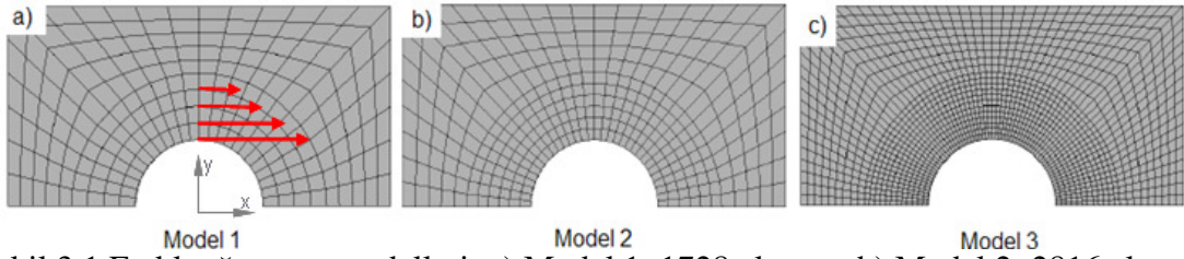
Şekil 3.1 Farklı ağ yapısı modelleri: a) Model 1: 1728 eleman, b) Model 2: 2816 eleman, c) Model 3: 11424 eleman
