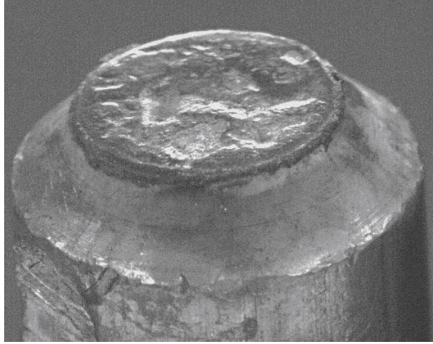
Şekil 6. Elektrod temas yüzeyinde oluşan çukurlaşmalar [15].
