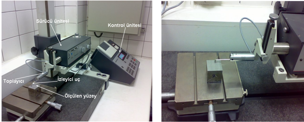
(a) (b) Şekil 2. Yüzey pürüzlülük ölçüm cihazı ve ölçüm işlemi
