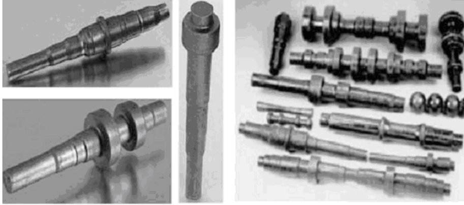
Şekil 4. Çapraz kamalı haddeleme ile üretilmiş bazı parçalar[3].
