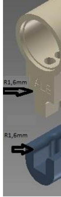
Şekil 12. Köşelere yarıçap uygulanmış tasarım durumu (R1,6mm)
