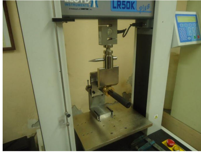
Şekil 19. Kuvvetin bilgisayar kontrolünde uygulandığı test düzeni
