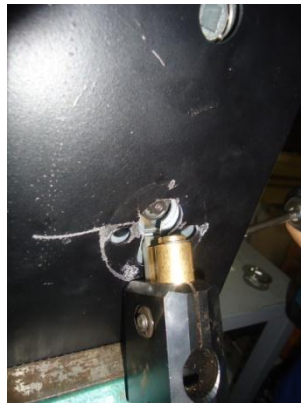
Şekil 8. Kupilyalı silindirin kırılma durumu
