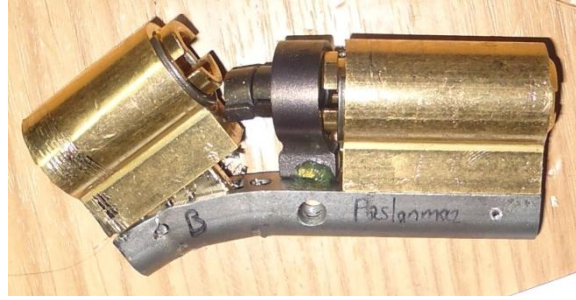
Şekil 9. Kupilyalı silindirin deforme olmuş hali
