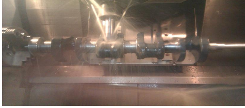
Şekil 7. Krank milinin CNC tezgahında işlenmesi
