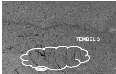
Şekil 10. Bir alüminyum SKK birleştirme kaynak dikişi mikroyapısında oluşan oksit hatalar (Tembel S) beyaz eğrilerle tanımlanan alan içerisinde görülmektedir [17].
