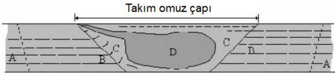
Şekil 1. Sürtünme karıştırma kaynak bölgeleri: (A) Ana malzeme, (B) Isı tesirinden etkilenen bölge, (C) Termomekanik olarak etkilenen bölge ve (D) Kaynak dikişi [2].
