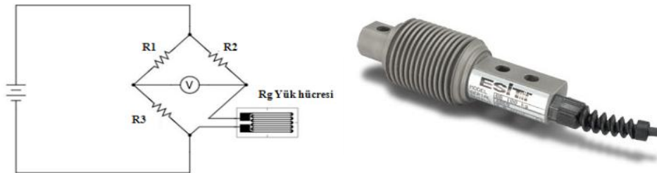
Şekil 3.4. Wheatstone Köprüsü ve Deneysel Cihazda Kullanılan Loadcell
