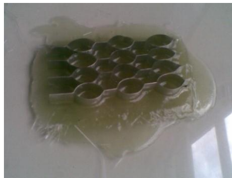
Şekil.5 Alüminyum petek yapının kompozitle kaplanması (H=16mm, T=15 mm)
