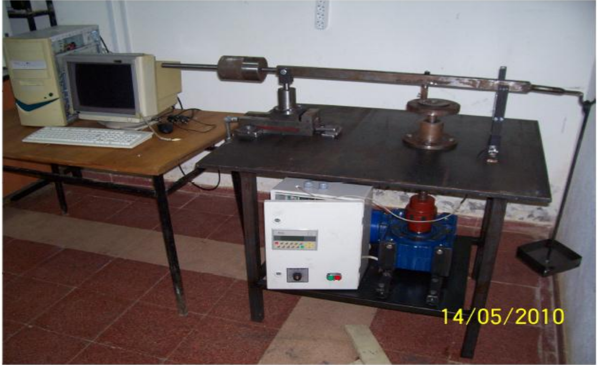
Şekil 1. Deneyde kullanılan disk üzeri pim aşınma cihazının görüntüsü
