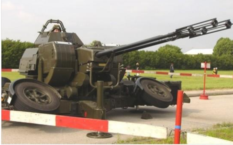
Şekil 1.Oerlikon GDF 003-35 mm çift namlulu uçaksavar topu [12].
