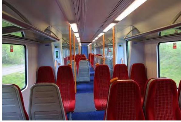
Şekil 11. Yangın geciktirici ve düşük duman özelliğine sahip SMC tren koltukları [23].
