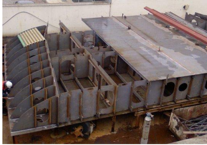
Şekil 1. Gemi tabanı sacları kaynaklı imalat uygulamaları
