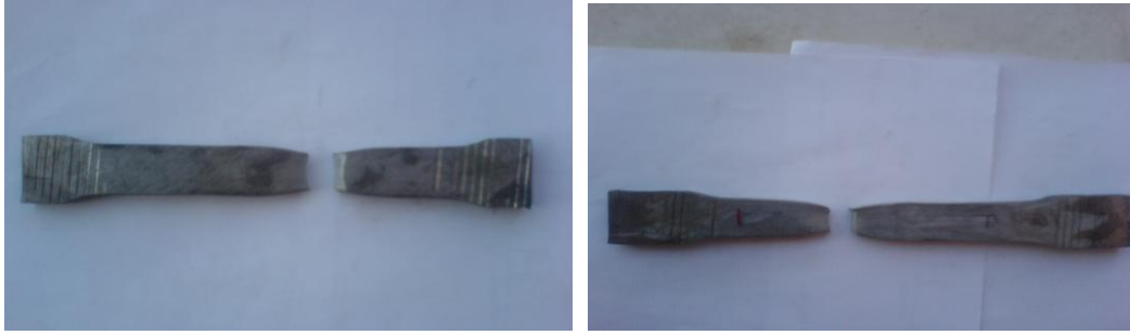
Şekil 6. a) Tozaltı çekme deneyi sonra numune b) Gazaltı çekme deneyi sonra numune
