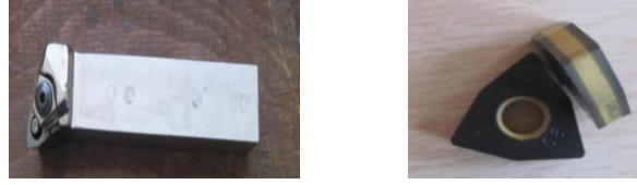
Şekil 2. Deneysel olarak kullanılan takım tutucu ve kesici uçlar
