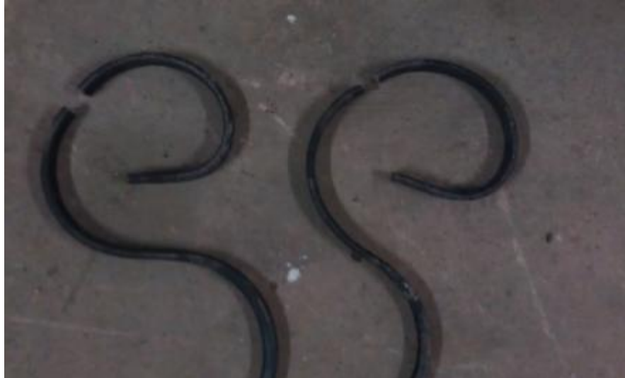
Şekil 9. Yorulma Testi Sonucu Kırılan S Tipi Ayaklar
