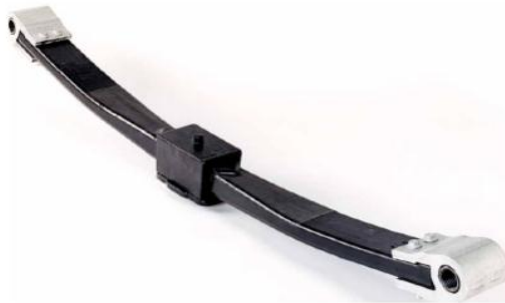
Şekil 4. Kompozit yaprak yay örneği
