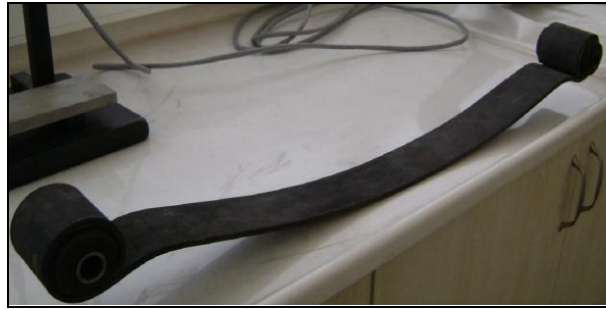
Şekil 15. 60 mm x 5 mm 55Cr3 yaprak yay
