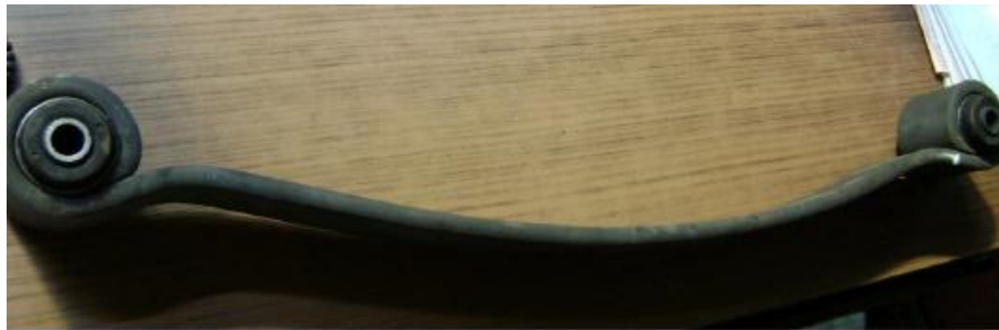
Şekil 22. 60 mm x 12 mm 55Cr3 yaprak yay
