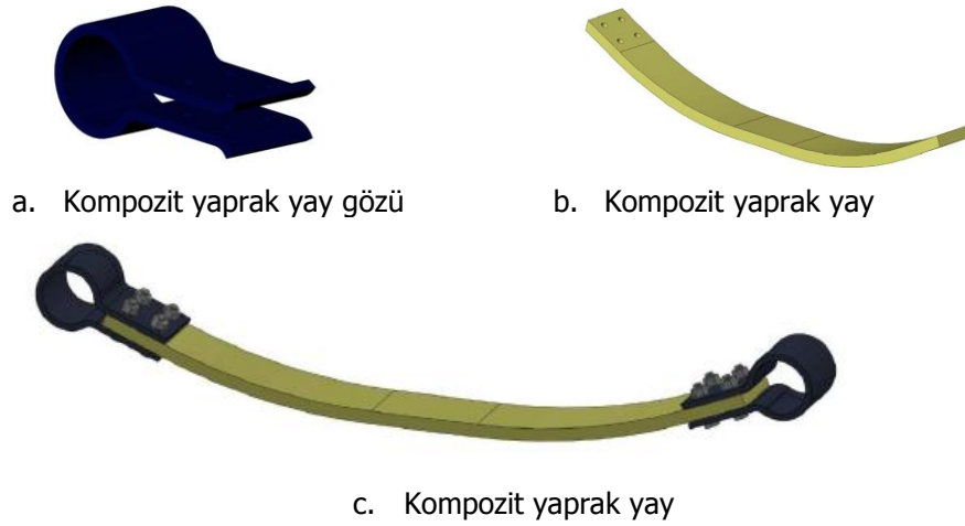
Şekil 5. Kompozit yaprak yayın çizimi
