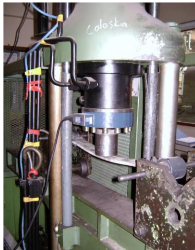
Şekil 7. Kompozit yaprak yay numunesine kuvvet uygulanması
