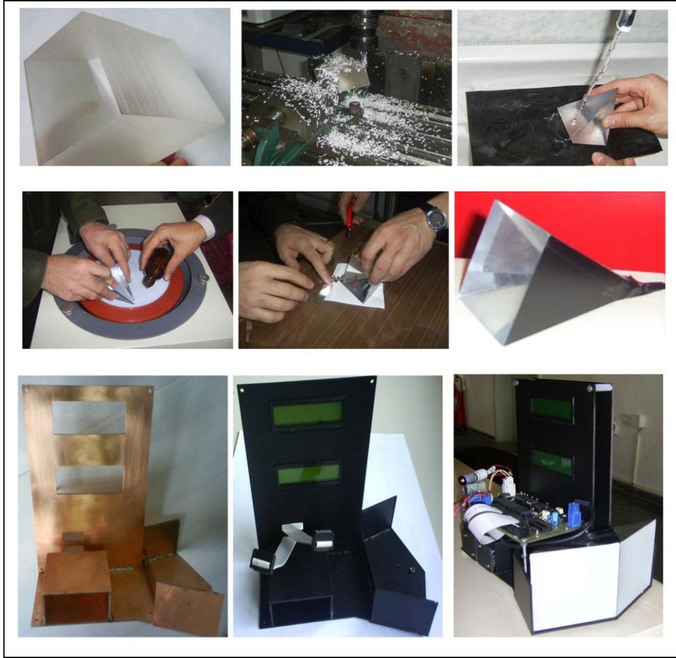
Şekil 18 Prizmanın ve sistemin üretim aşamaları
