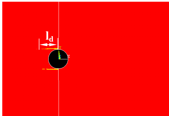
Şekil 5. [90^\circ/0^\circ]_s numunesinin maksimum yük altında 90^\circ/0^\circ ara yüzeyindeki delaminasyon hasarı ( l_d :delaminasyon uzunluğu = 6 mm)
